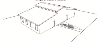
Figura 1. Acesso Frontal. Elemento de ventilação da cobertura, rampa para remoção de dejetos e chorume.
