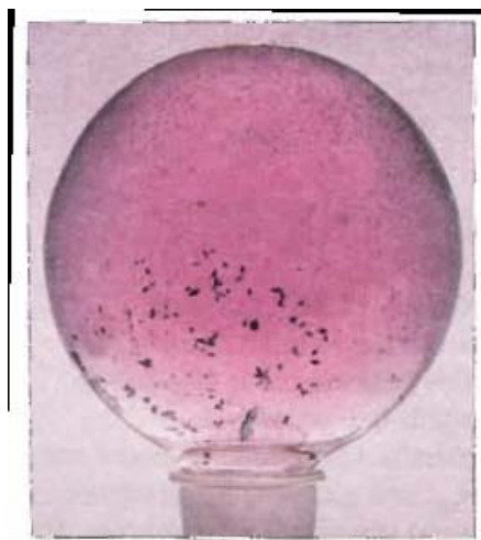
Figura1- Iodo sólido em equilíbrio com seu vapor [1].
